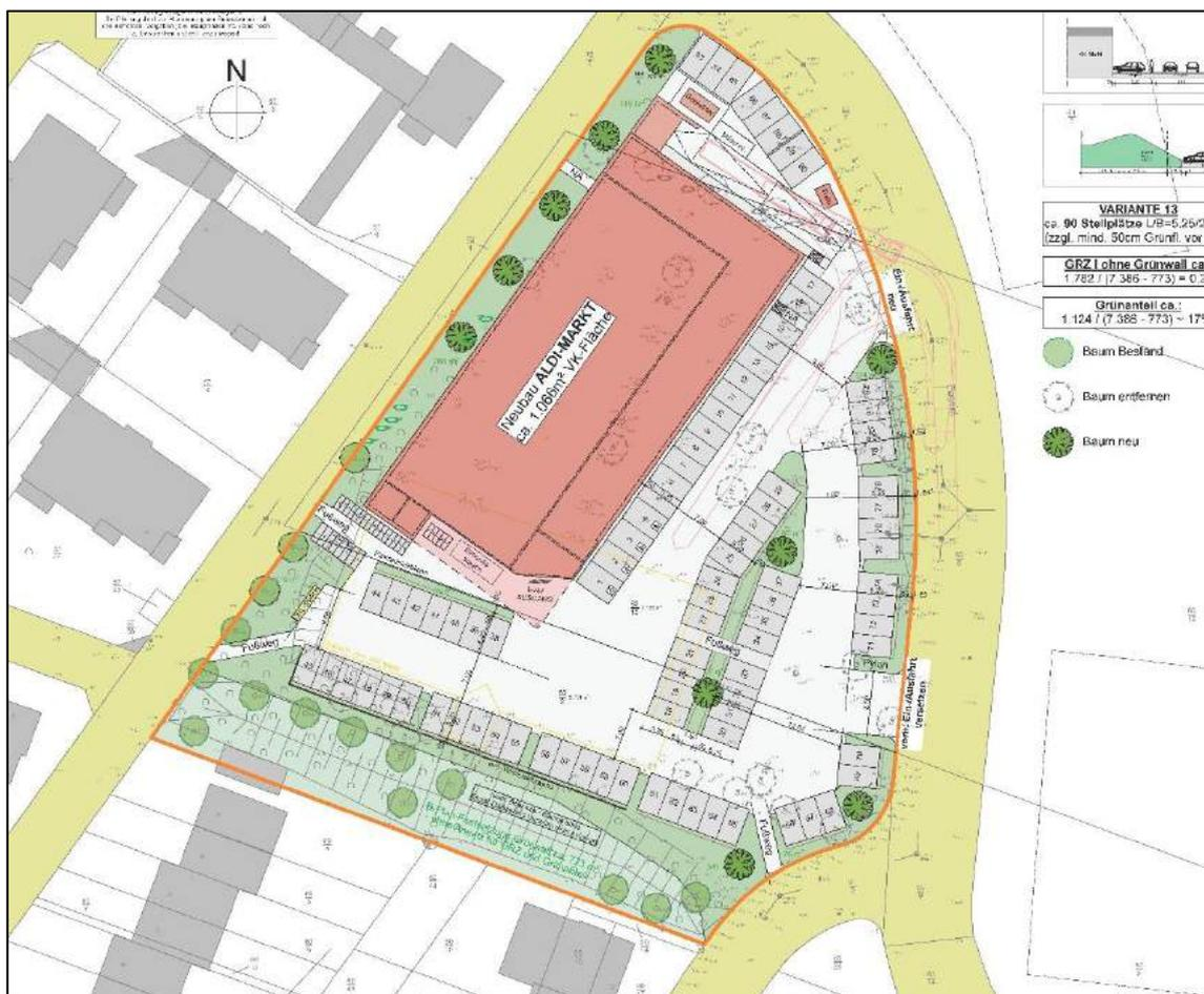
Abb. 2: Lageplan zum Bauvorhaben /13/
